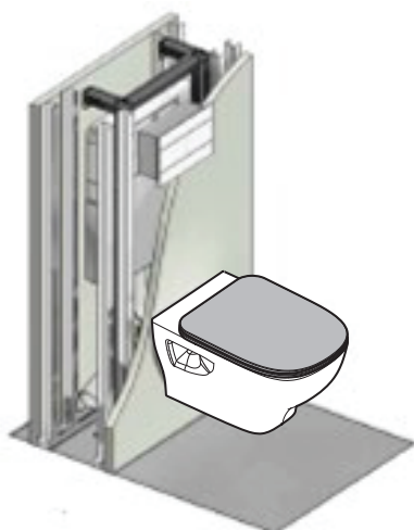
Pose dans une cloison avec ossature métallique
